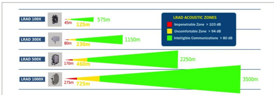
รูปที่ ๓ เขตลำเสียงจากแอลอาร์เอทีรุ่นต่าง ๆ (Acoustic Deterrent System, 2014)
