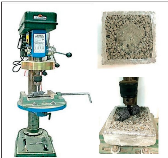
รูปที่ ๙ การทดสอบการต้านทานการสึกกร่อนของตัวอย่างคอนกรีตพูน (ยุวดี แซ่ตั้ง, ๒๕๕๗)
